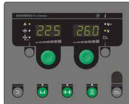
Advanced панел с функция PowerArc™ и DUO Plus™. DUO Plus осигурява ВИГ-образна заварка и по-добър контрол на заваръчната вана. Панелът съдържа програми за МИГ завароспяване и заваряване с флюсова и твърда тел на черна и неръждаема стомана и алуминий.
